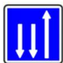
Section de route à trois voies affectées
